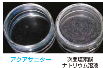
有効塩素濃度30ppmの溶液3mlを30mm径のガラスシャーレの中で乾燥させました。
